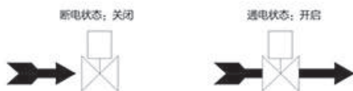
常闭电磁阀开关状态图
