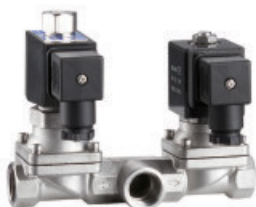
控制方式：一进一出（换向型）B型 (1为供应口，2常开位、3常闭位为出口换向)
