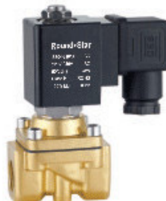
2W-A-08/15ES 主阀配置: 2W系列(P021) 常规电压: AC220V 3VA DC24V 4W
